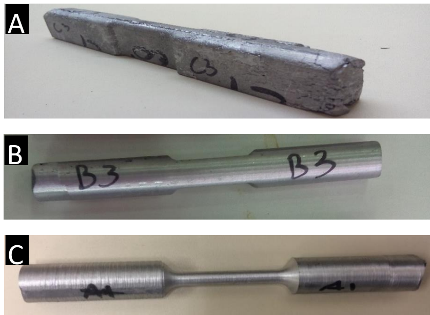
Figura 12 - Processo de Usinagem (A - Amostra pré usinagem / B - Peça que sofreu usinagem com torno convencional com castanha de 4 pontos / C - Peças usinada com torno CNC ).
