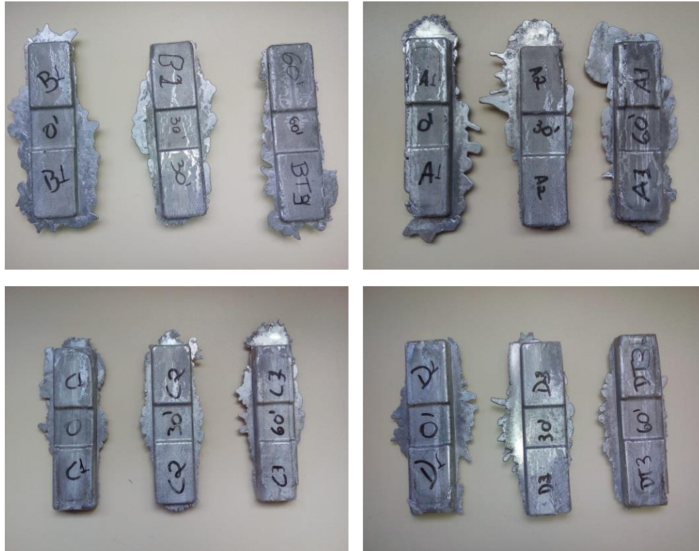
Figura 10 - Amostras resultantes do processo de tixoconformação com variação de tempo na fase semisólida.
