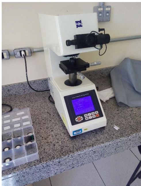
Figura 17 - Microdurômetro durante a realização do ensaio.
