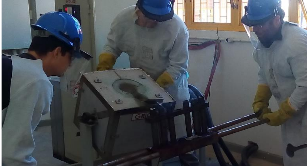
Figura 7 - Processo de fundição das ligas de alumínio com variação de modificador e refinador.
