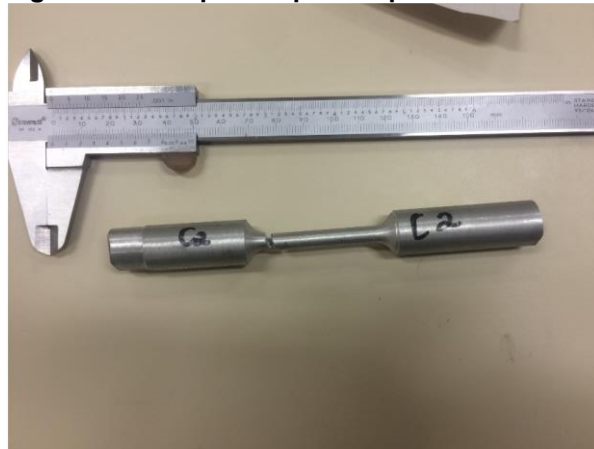
Figura 23 – Corpos de prova após ensaio de tração.
