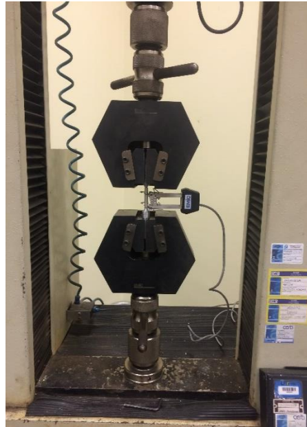
Figura 2- Equipamentos utilizados para ensaio de tração.
