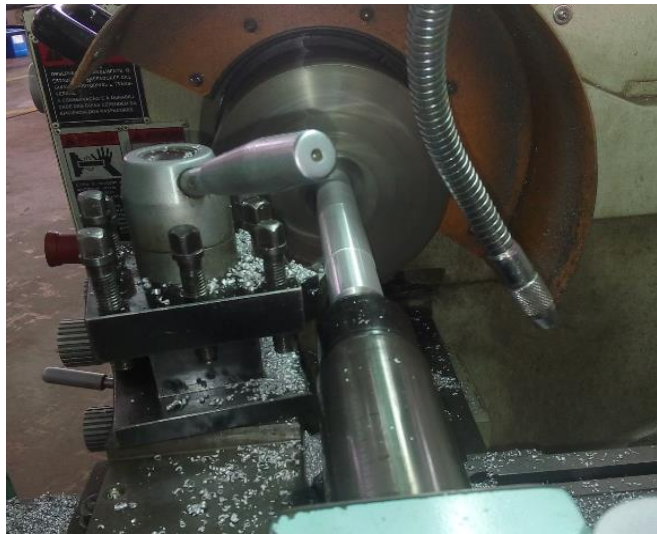
Figura 8 – Usinagem dos tarugos para o processo de tixoconformação.
