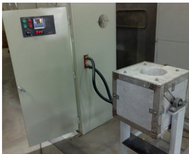
Figura 6 - Forno de Indução Grion
