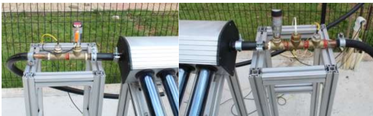
Figura 40 – Entrada e saída do coletor solar.
