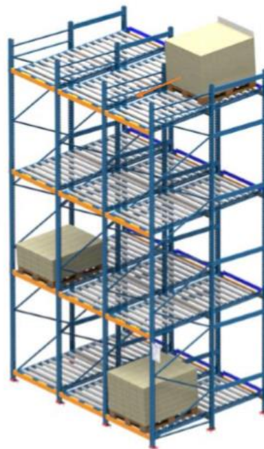
Figura 7 - Sistema de armazenagem Push Back
