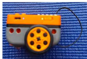
**Conecte o mCenter+ ao corpo (base cinza), veja que os círculos facilitam essa fixação. Preste atenção ao colocar o cabo de conexão, ele deve estar conectado a uma porta digital. Depois ligue o Ludobot com o botão lateral, deslizando-o para esquerda. Depois é só aproximar a montagem do celular com o aplicativo aberto e aguardar a conexão via bluetooth.**
