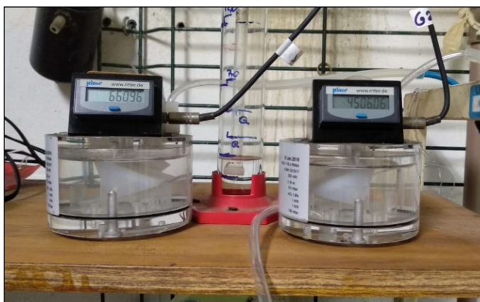
Figura 7 – Medidores de vazão de biogás no reator UAHB
