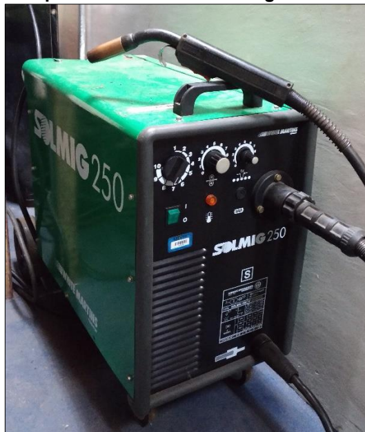
Figura 10 – Máquina de Solda MIG Solmig250 WHITE MARTINS.
