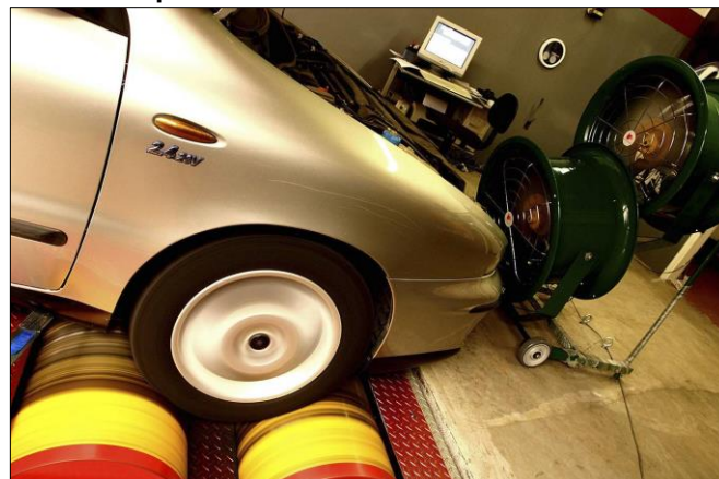
Figura 6 – Ensaio de performance de veículo em dinamômetro de chassi.
