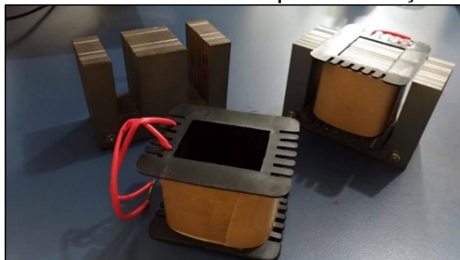
Figura 14 – Bobinas e núcleos utilizados para a construção do eletroímã.
