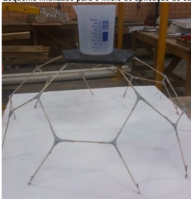
Figura 19 – Esquema finalizado para o início de aplicação de carregamento.
