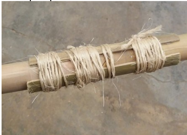
Figura 59 – Corpo de prova utilizando colmos de bambu como reforço.
