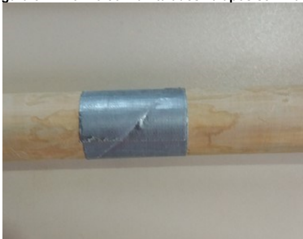
Figura 57 – Colmo com a fita adesiva após ser lixado.
