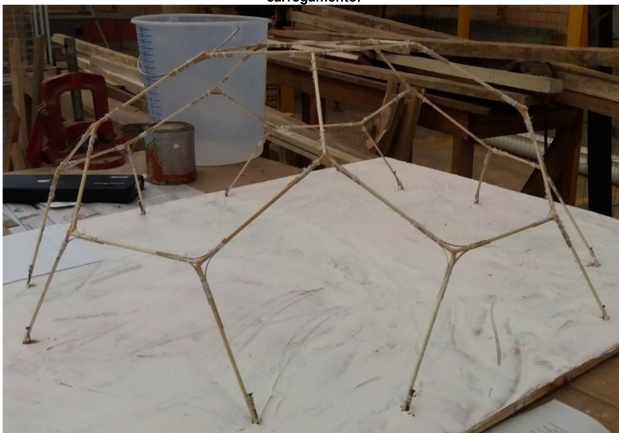
Figura 29 – Maquete2 sem aplicação de massa plástica finalizada para início do primeiro carregamento.
