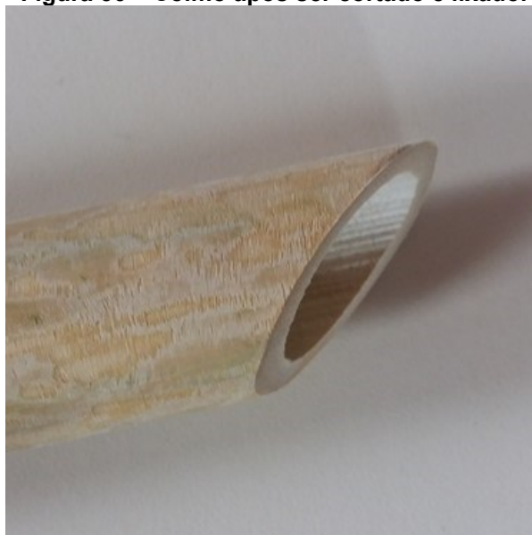
Figura 56 – Colmo após ser cortado e lixado.
