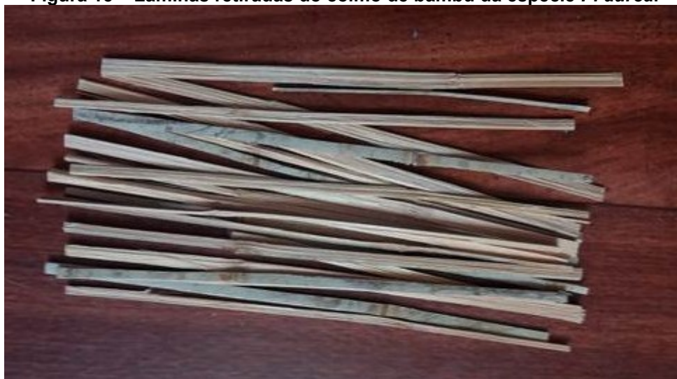
Figura 15 – Lâminas retiradas do colmo de bambu da espécie P. aurea .
