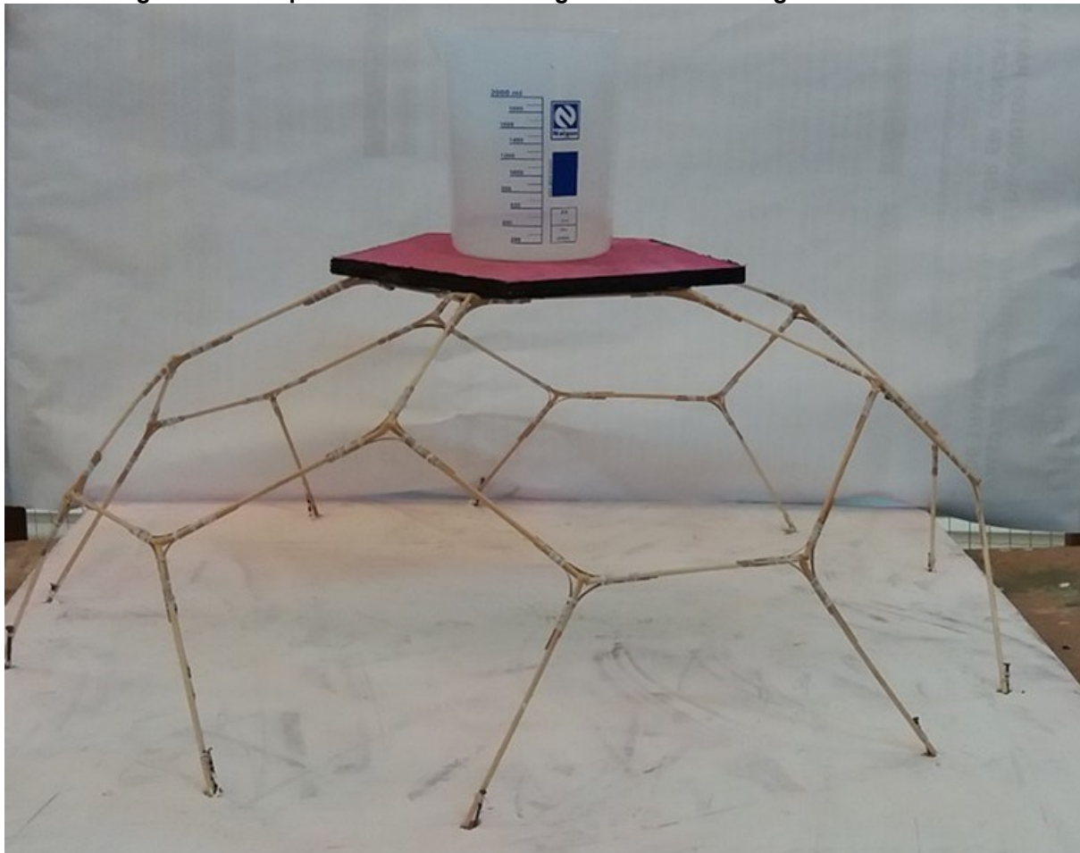
Figura 37 – Maquete 2: ensaio do carregamento 1 ao carregamento máximo.
