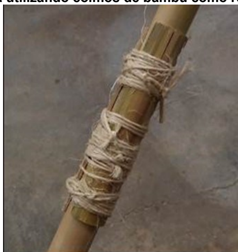
Figura 66 – Corpo de prova utilizando colmos de bambu como reforço e sisal após o ensaio.
