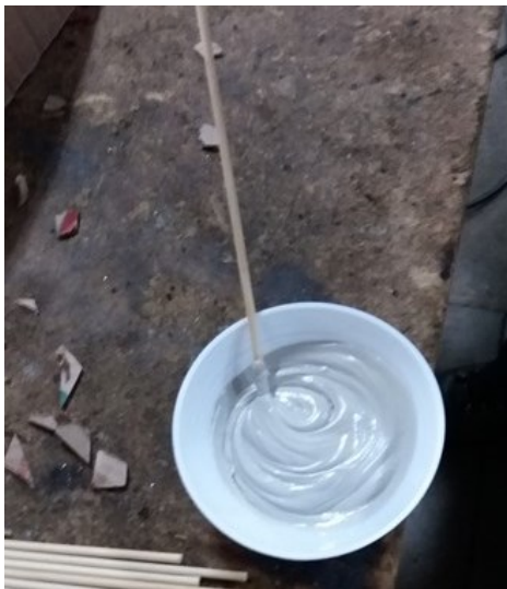
Figura 13 – Recipiente contendo massa e o catalizador durante o preparo da massa plástica.
