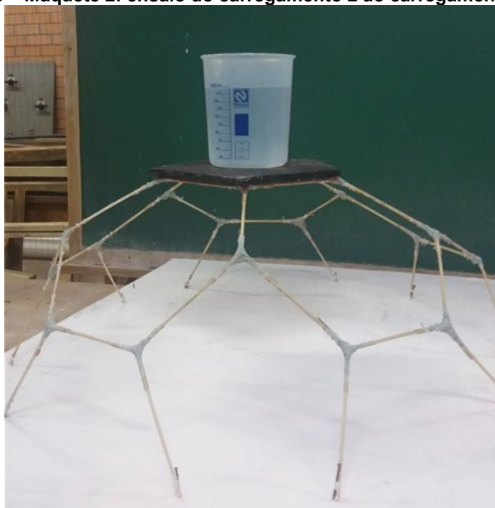
Figura 38 – Maquete 2: ensaio do carregamento 2 ao carregamento máximo.
