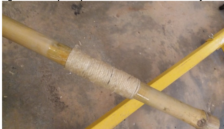
Figura 62 – Corpo de prova com o sisal mais a resina já seca.
