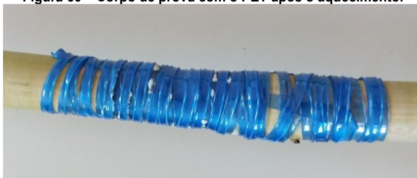
Figura 60 – Corpo de prova com o PET após o aquecimento.
