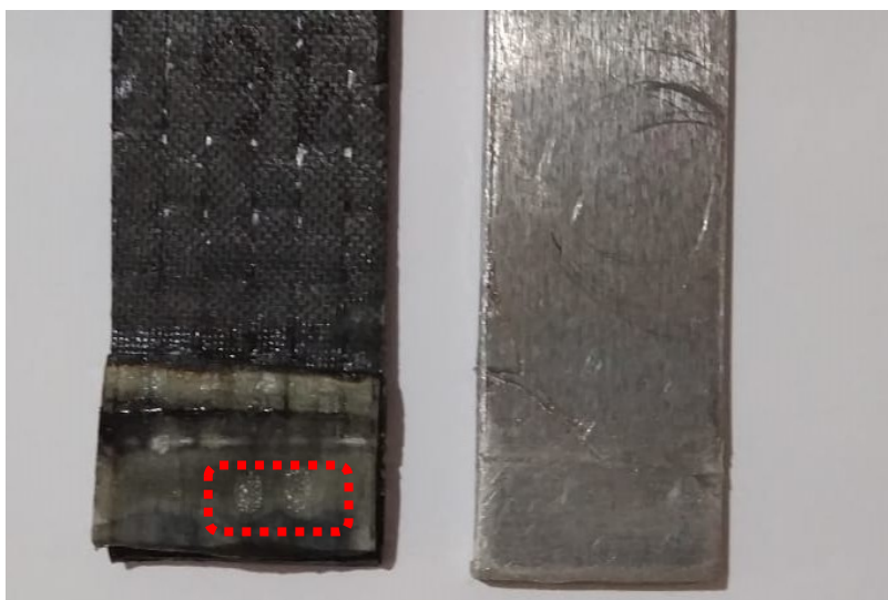
Figura 39 – Falhas na superfície da junta 16
