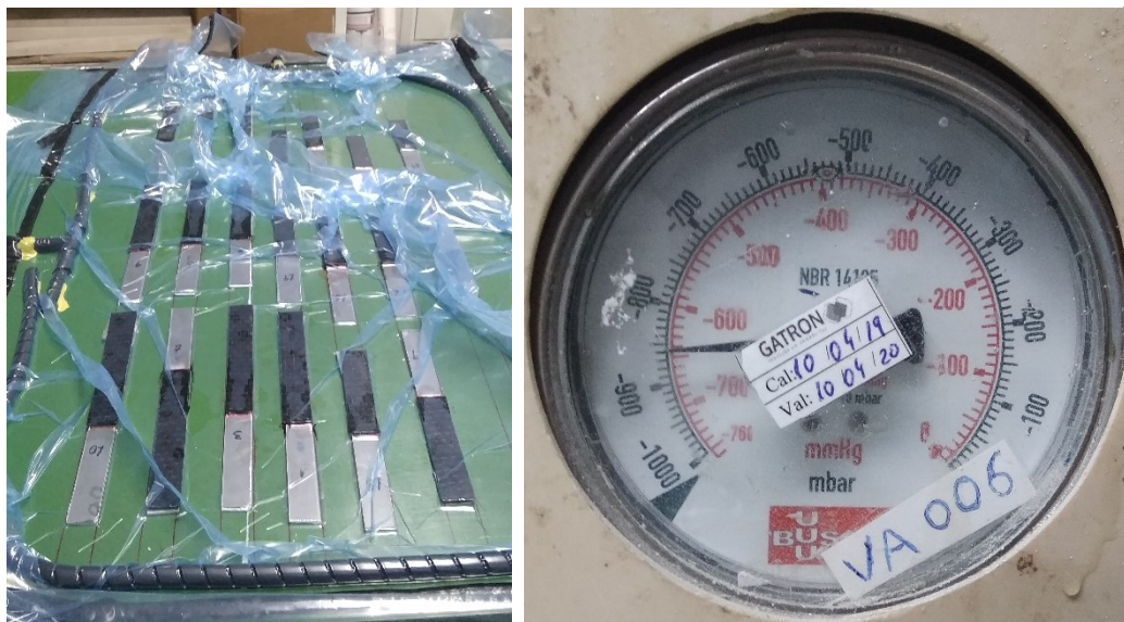
Figura 23 - a) Corpos sob a aplicação de vácuo; b) Pressão de Vácuo mantida constante por 8h.
