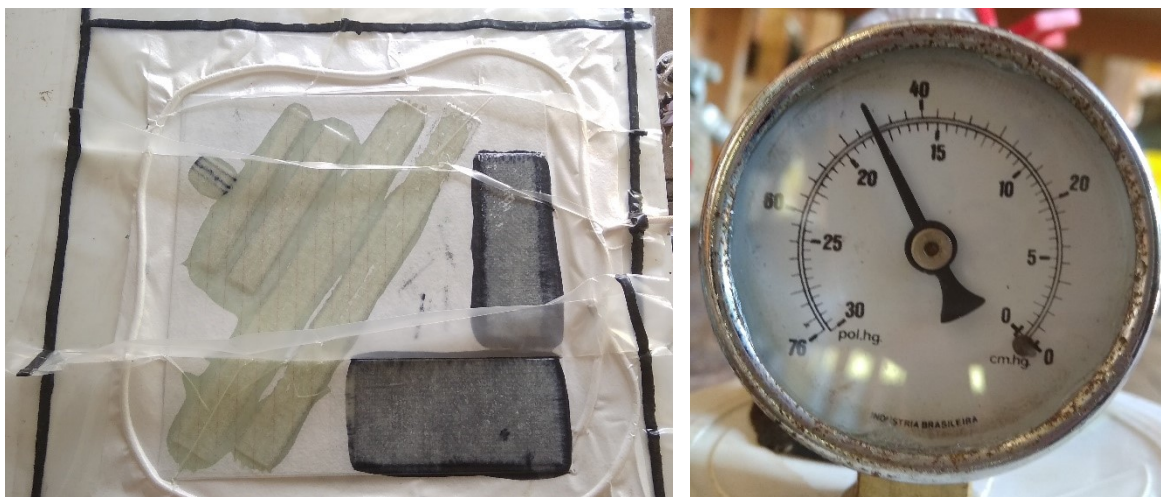
Figura 18 - a) Corpos sob a aplicação do vácuo; b) Pressão de Vácuo mantida constante por 8h.
