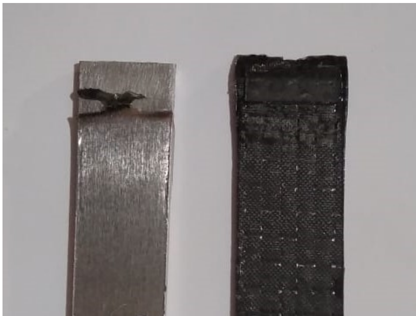
Figura 34 – Falha do tipo mista, apresentada pelo corpo de prova 13.
