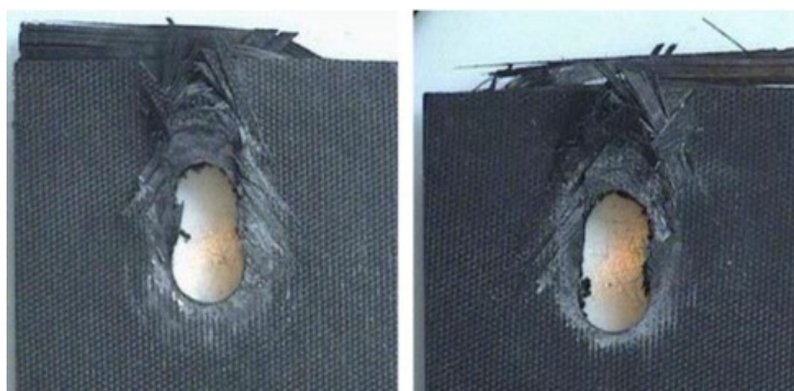
Figura 9 - Delaminação após a falha de uma junta mecânica por parafuso
