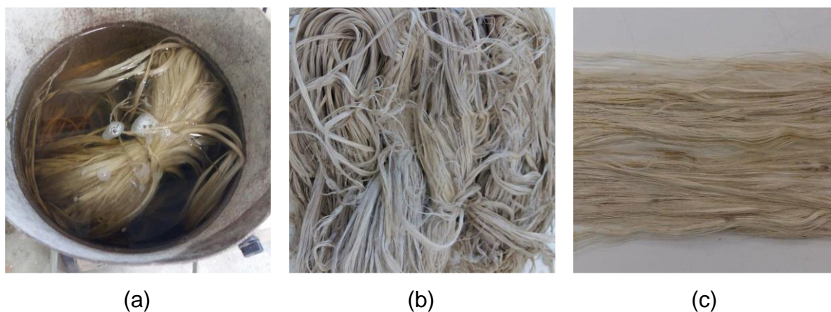
Figura 18 - Procedimentos de preparação da fibra: lavagem (a), secagem (b) escovação (c)
