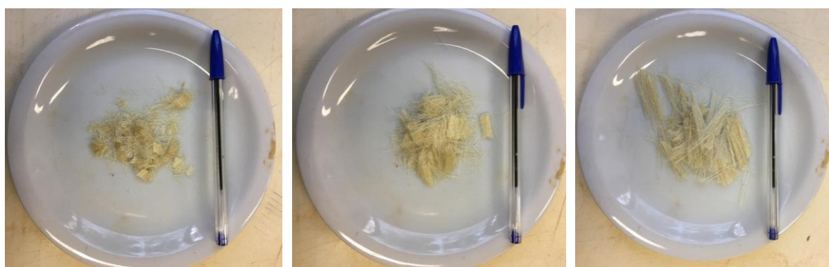
Figura 19 - Procedimento de corte das fibras em 6mm (a), 15mm (b) e 30mm (c)
