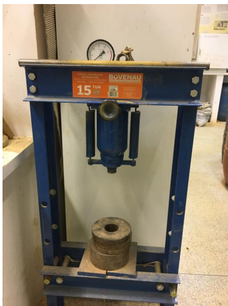
Figura 21 - Prensa para compactação dos corpos de prova
