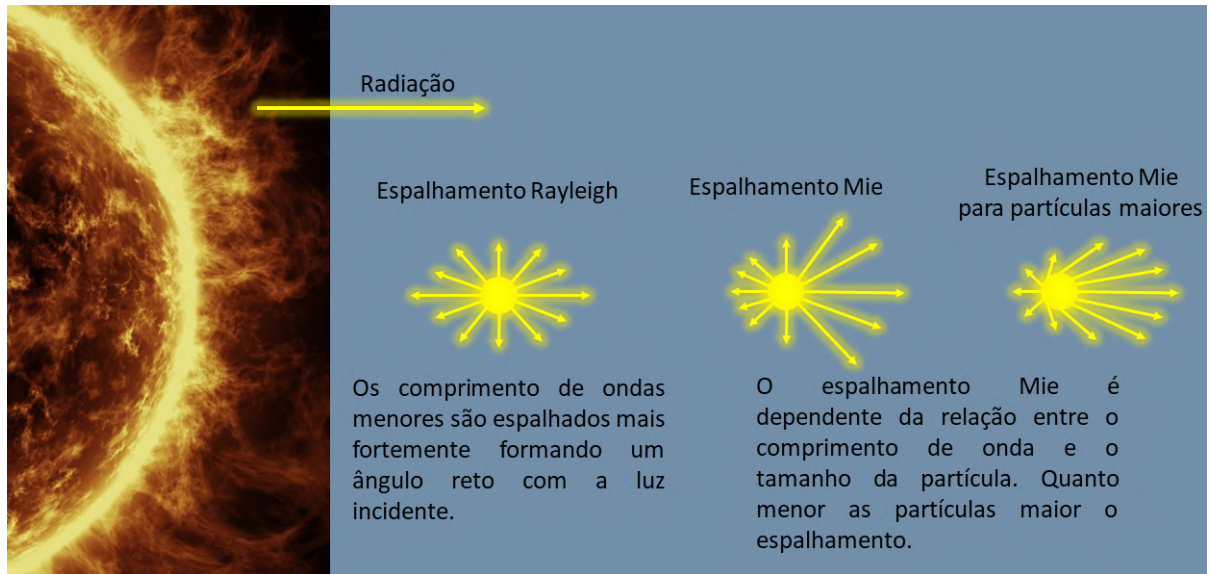
Figura 22 – Comparação entre os espalhamentos de Rayleigh e Mie. Adaptado de (KLEBER et al. , 2011)
