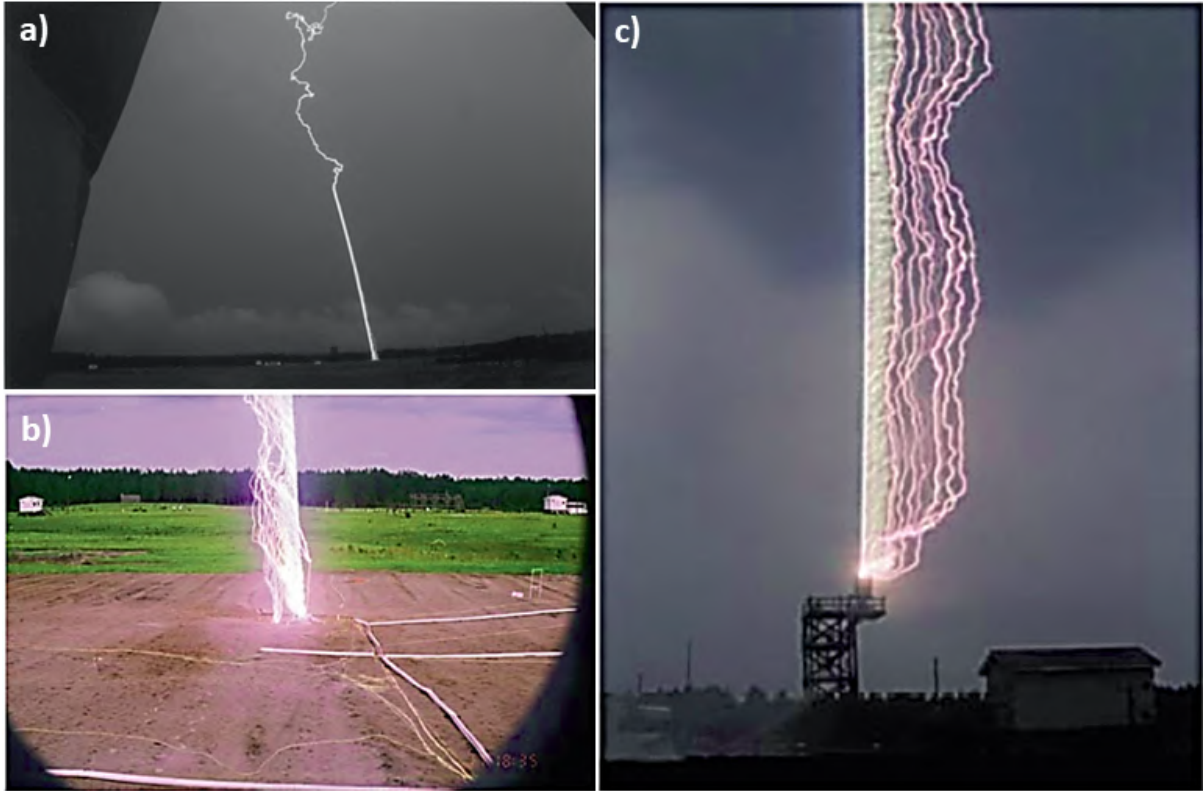
Figura 19 – Fotografias de relâmpagos disparados em Camp Blanding, Flórida: (a) uma visão distante de uma descarga na pista de teste; (b) um ataque iniciado pelo lançador subterrâneo no centro de uma grade metálica enterrada de 70 \times 70 \text{ m}^2 ; (c) uma descarga ao sistema de potência de teste iniciado a partir do lançador da torre. Adaptado de (RAKOV, 2008)
