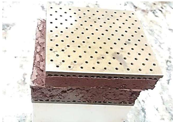
Figura 11 - Ruptura de corpo de prova após ensaio de cisalhamento
