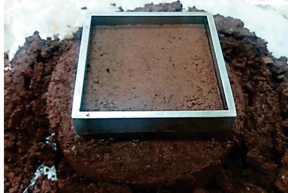
Figura 8 - Moldagem do corpo de prova para ensaio de cisalhamento
