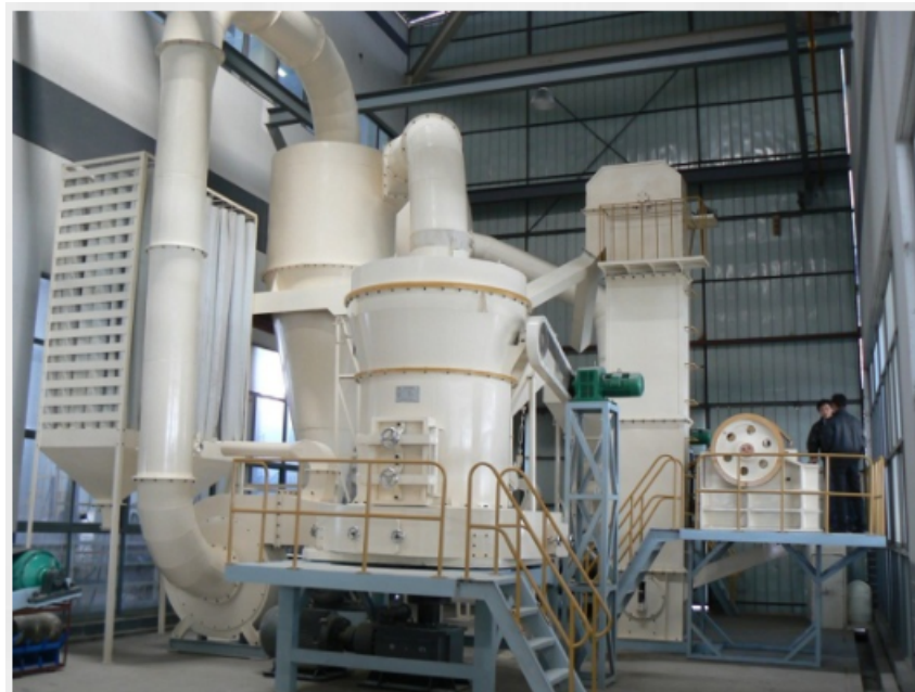
Figura 6: Planta de operação com moinho Raymond
