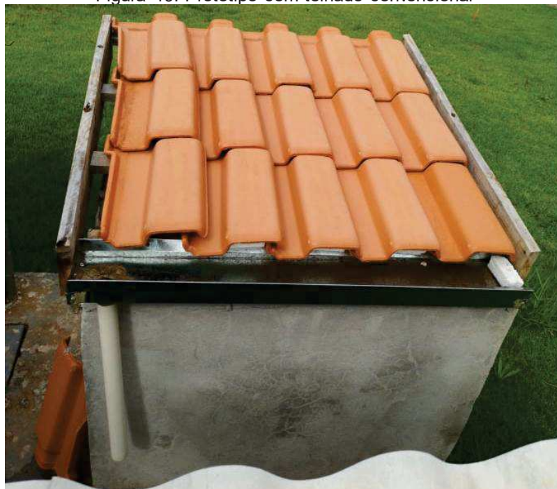
Figura 19: Protótipo com telhado convencional
