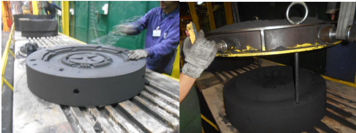
Figuras 12 e 13: Montagem dos moldes Fonte: O autor (2020)
