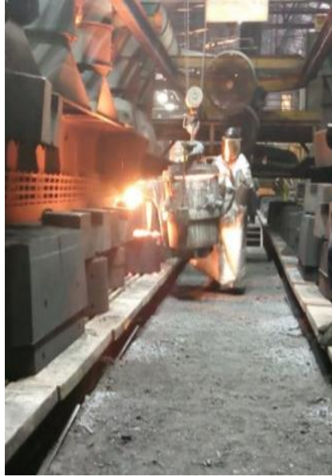
Figura 14: Vazamento do molde Fonte: O autor (2020)
