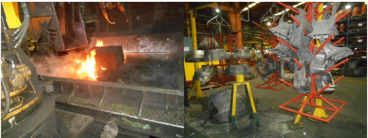
Figuras 15 e 16: Desmoldagem do molde e colocação das peças em gancheiras Fonte: O autor (2020)
