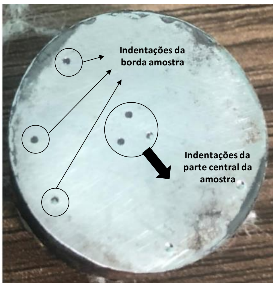
Figura 12 - Indentações na parte central e na borda da amostra com raio de 25,4 mm de um AISI 1045
