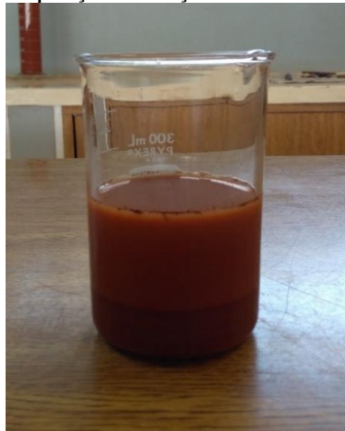
Fotografia 5– Preparação de solução de hexametáfosfato de sódio
