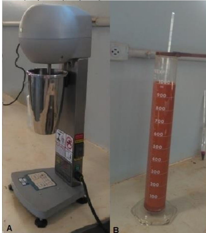
Fotografia 6- A (dispersor); B (solução de solo no início da sedimentação)
