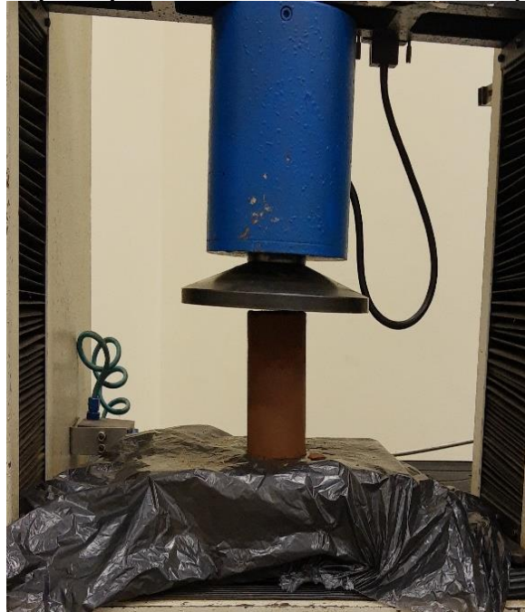
Fotografia 9– Corpo de prova submetido ao ensaio de compressão simples
