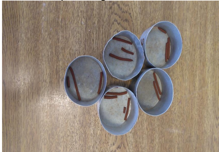
Fotografia 3- Aspecto das amostras do ensaio de plasticidade após a secagem em estufa
