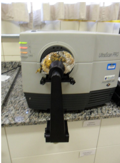
Figura 3: aparelho utilizado na análise de cor dos frutos.
