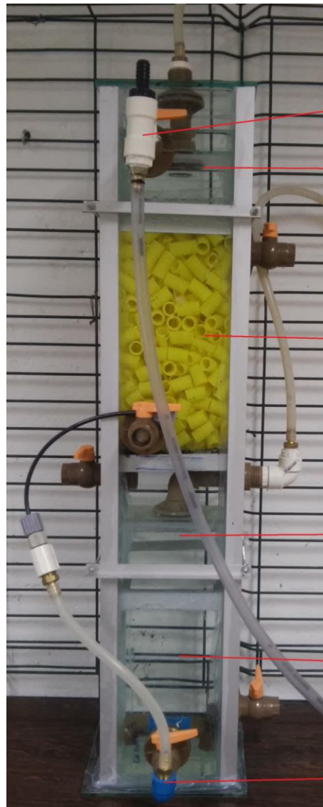
Figura 6 - Foto do Reator UAHB (esquerda) antes da inoculação do lodo flocculento anaeróbio e Esquema do Reator UAHB (direita) em escala de bancada.
