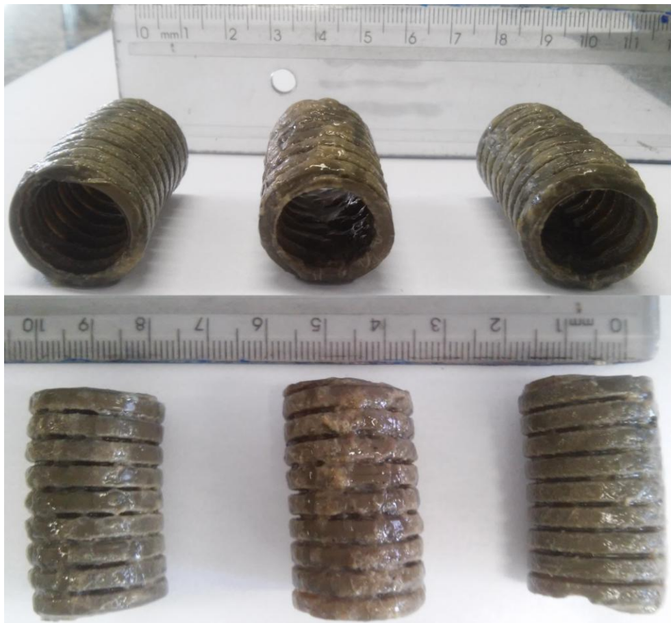
Figura 17 - Formação do biofilme nos anéis de conduítes corrugados que formavam o meio suporte do reator UAHB após um ano de operação.
