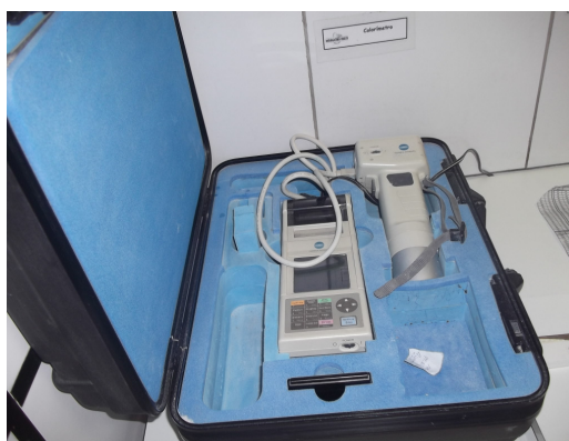
Figura 10: Colorímetro Minolta Fonte: Moageira (2011)
