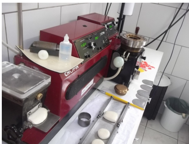
Figura 14: Alveógrafo Chopin Fonte: Moageira (2011)
