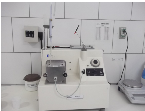
Figura 17: Farinógrafo Brabender. Fonte: Moageira (2011)
