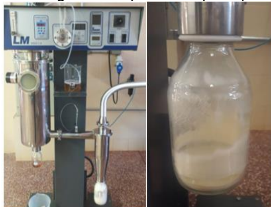
Figura 8 - Processo de secagem da aquafaba líquida por atomização.
