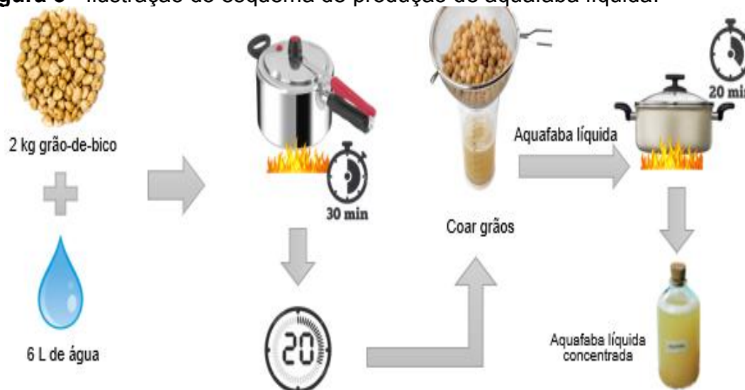
Figura 3 - Ilustração do esquema de produção de aquafaba líquida.
