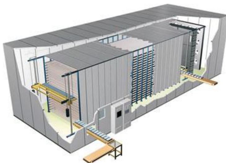
Figura 9 - Túnel de congelamento contínuo
