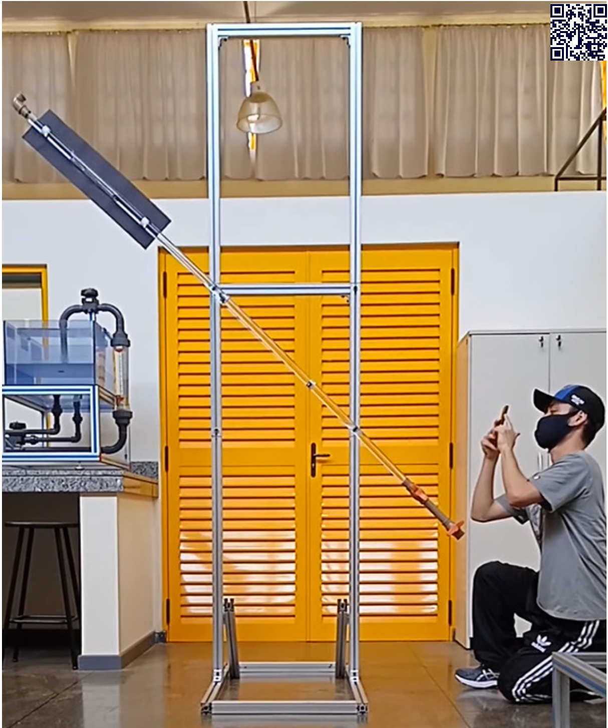
Fotografia 4 – Procedimento operacional realizado no aparato experimental para o caso inclinado ( 45^\circ )
