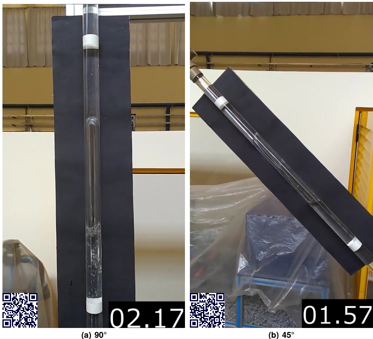
Fotografia 5 – Testes para determinação da velocidade de ascensão de uma bolha alongada de ar escoando em um tubo contendo um líquido estagnado (água)
