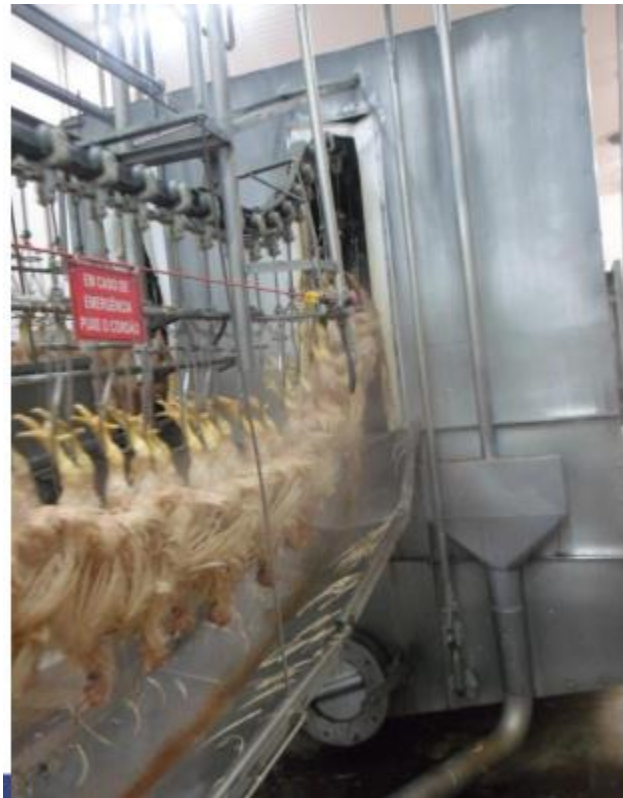
Figura 6: Processo de escaldagem das aves
