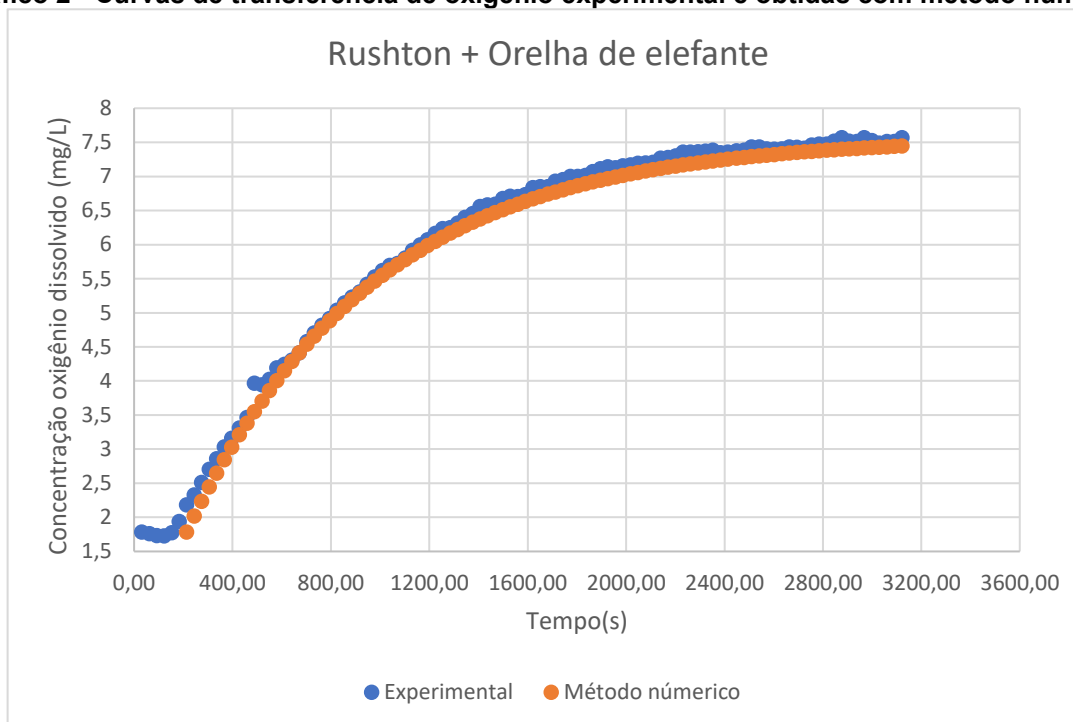
Gráfico 2 - Curvas de transferência de oxigênio experimental e obtidas com método numérico
