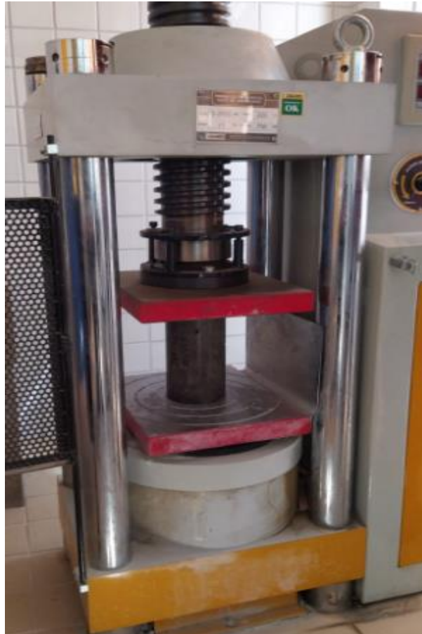
Figura 20 - Ensaio de compressão do Corpo de prova
