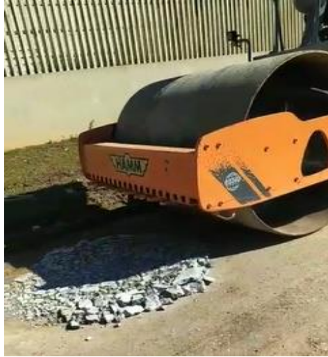
Figura 11 – Rolo compactador utilizado para britagem do material
