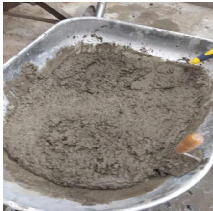
Figura 24 - Concreto produzido com proporção 100/0
