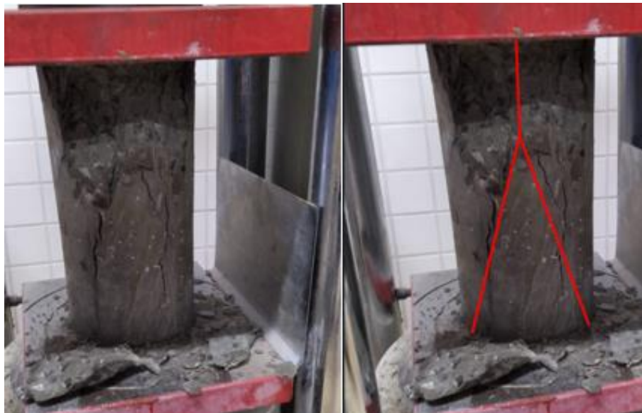
Figura 28 - Ruptura cônica e bipartida
