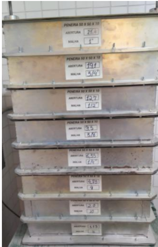
Figura 13 - Agitador mecânico com a série de peneiras utilizadas para granulometria
