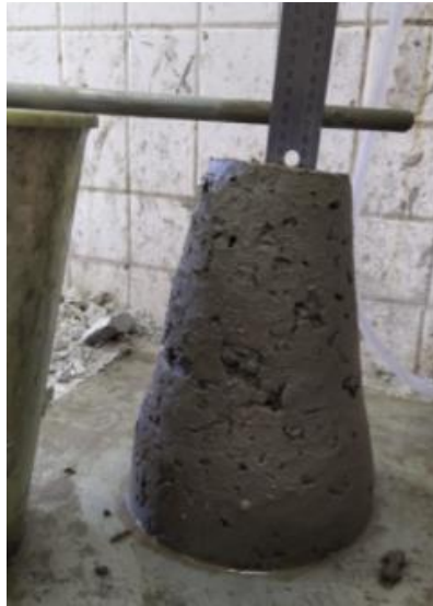
Figura 25 - Slump Test do concreto com proporção 15/85
