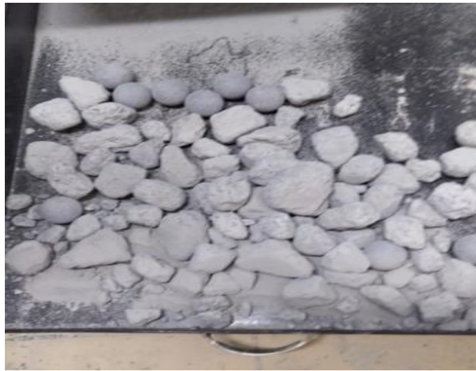
Figura 10 - Material desgastado na tentativa de britagem
