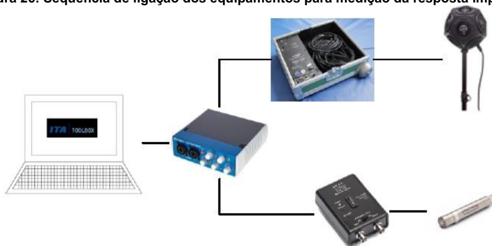
Figura 26: Sequência de ligação dos equipamentos para medição da resposta impulsiva.
