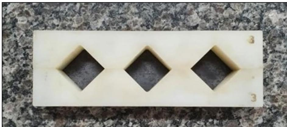
Figura 18: Moldes cúbicos 30x30x30 mm.
