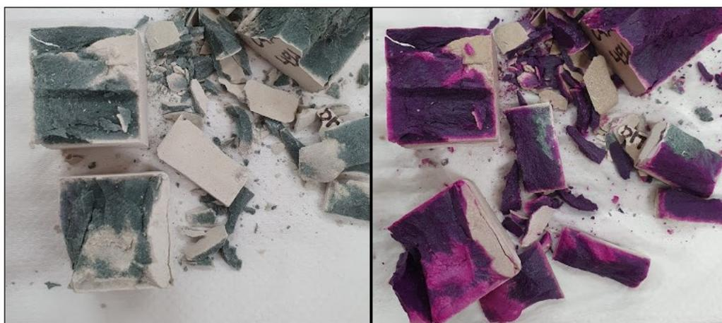
**Figura 29: Comparação visual entre os corpos de prova submetidos ao processo de cura 4 (C:ar), aos 58 dias de hidratação, antes e após aspersão de fenolftaleína.**
