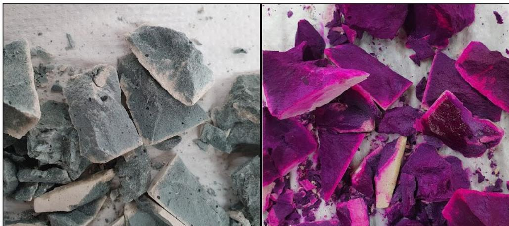
**Figura 31: Comparação visual entre os corpos de prova submetidos ao processo de cura 3 (C:úmida), aos 92 dias de hidratação, antes e após aspensão de fenolftaleína.**
