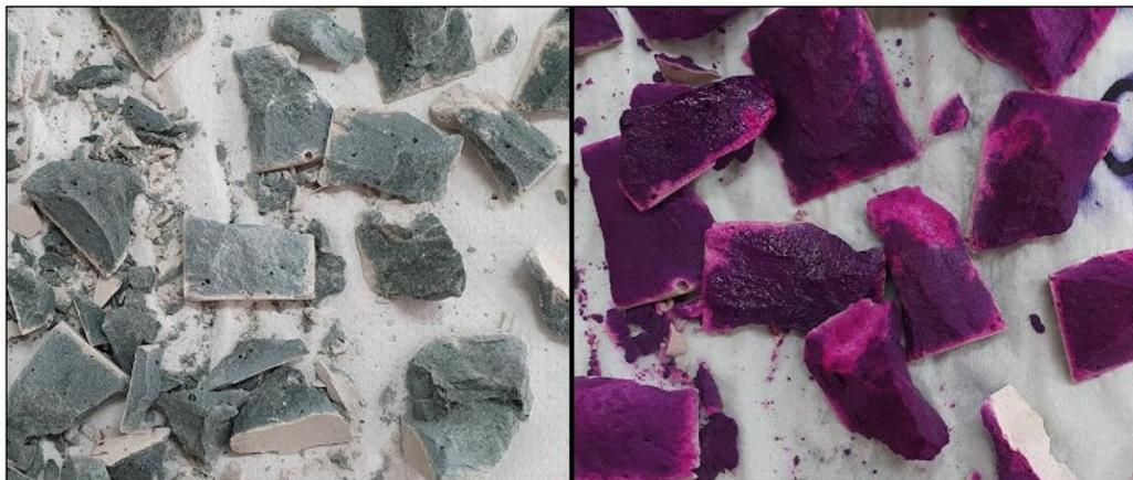
**Figura 32: Comparação visual entre os corpos de prova submetidos ao processo de cura 4 (C:ar), aos 92 dias de hidratação, antes e após aspersão de fenolftaleína.
