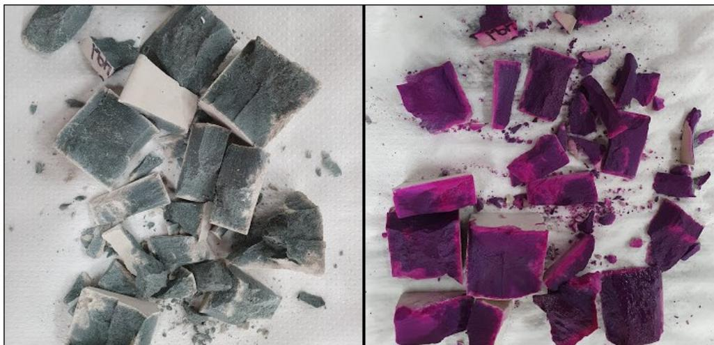
**Figura 28: Comparação visual entre os corpos de prova submetidos ao processo de cura 3 (C:úmida), aos 58 dias de hidratação, antes e após aspersão de fenolftaleína.**
