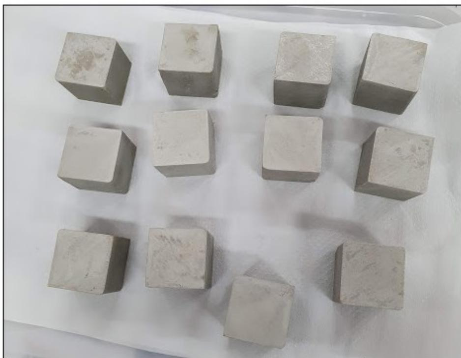
**Figura 24: CP's de CSS utilizados no teste de resistência à compressão, logo após desmoldagem.**
