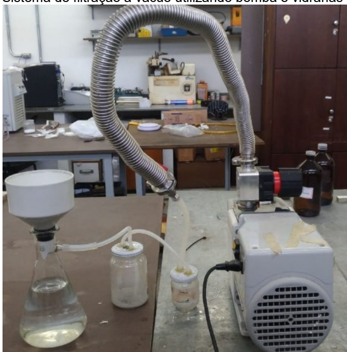
Figura 2 – Sistema de filtração à vácuo utilizando bomba e vidrarias apropriadas
