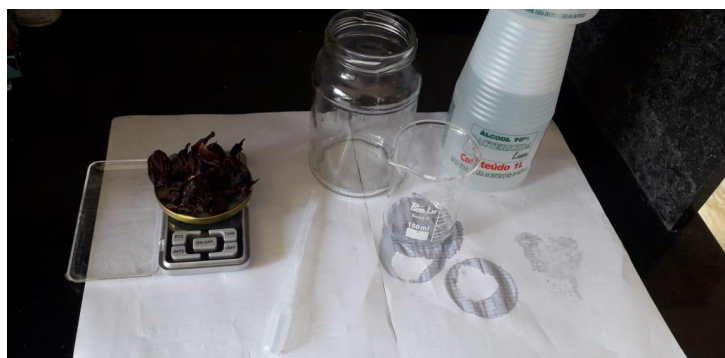
Figura 21 – (a) Aparato necessário para a extração em aulas remotas usando a Hibiscus sabdariffa L. (b) extração a frio feita em frasco de azeitona higienizado.
