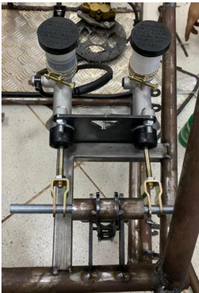
Figura 20 – Montagem preliminar do sistema balance bar .
