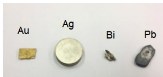
Figura 13 - Alvos metálicos utilizados para a ablação e obtenção nas Nps (da esquerda para direita: Au, Ag, Bi e Pb).
