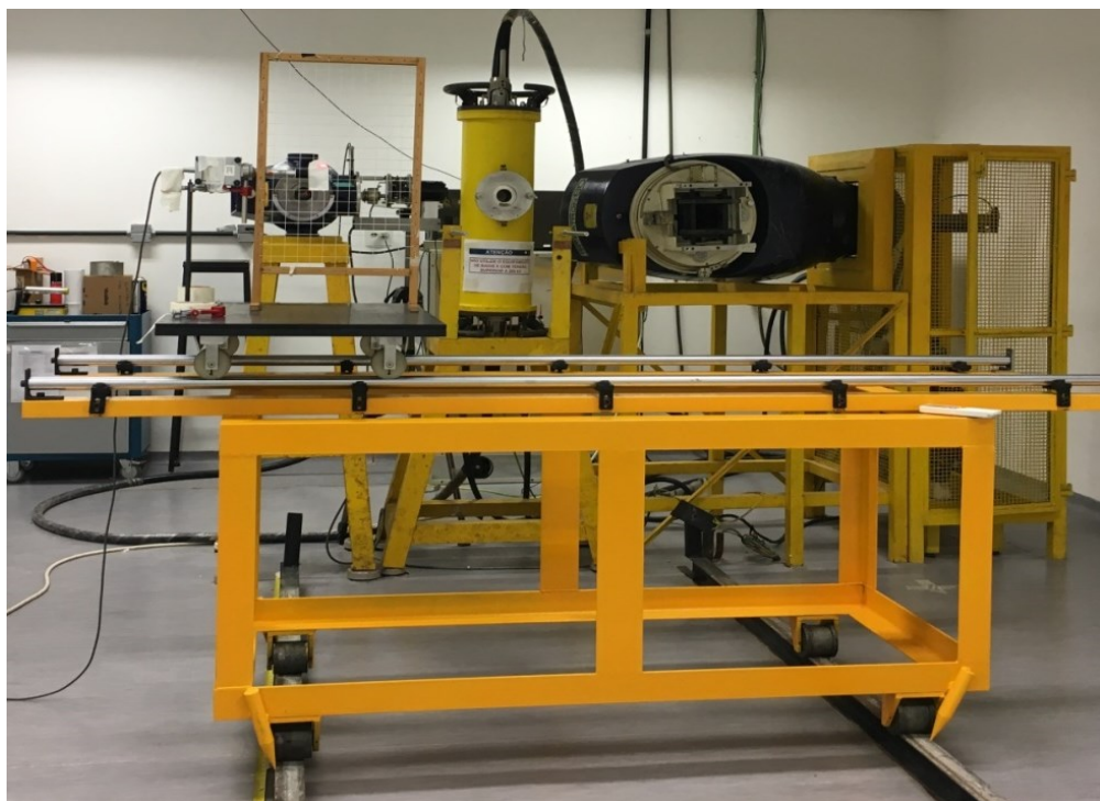
Figura 23 - Fontes radioativas dispostas na sala de fontes do GFMDR-IFUSP. Da esquerda para direita: Fonte de ^{137}\text{Cs} , Tubo de raios X industrial e fonte de ^{60}\text{Co} .
