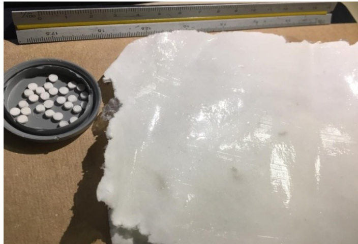
Figura 11 - Detectores de \text{CaF}_2 em pastilha (esquerda) produzidos a partir da folha detectora flexível OSL de \text{CaF}_2 (direita).
