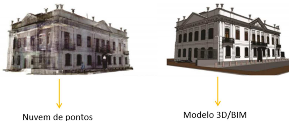
Figura 6: Elaboração modelo 3D/BIM através de levantamento por nuvem de pontos. Fonte: Arquivo Retrô Projetos, 2016.
