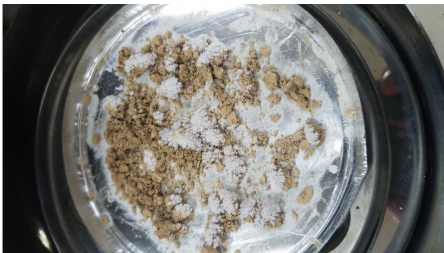
Figura 6 – Extrato seco de Hansenula wingei pós secagem por infravermelho
