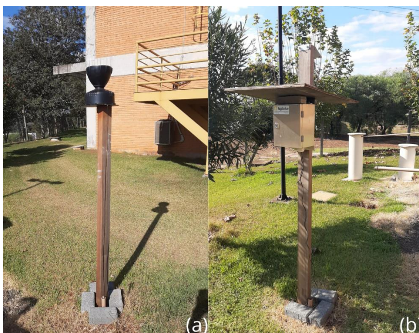
Figura 12 - Instalação dos instrumentos de monitoramento: (a) pluviômetro de bascula; (b) datalogger e placa solar que alimenta a energia elétrica do datalogger. Fonte: Acervo pessoal (2021).
