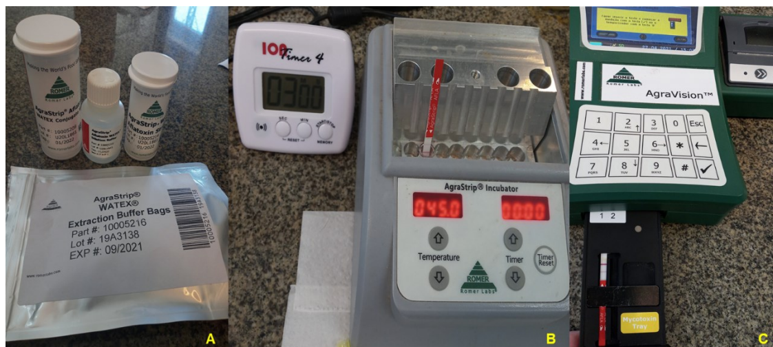
Figura 6 – Em (A) Kit AgraStrip Watex; (B) Fita inserida na incubadora; (C) Leitor Agravision
