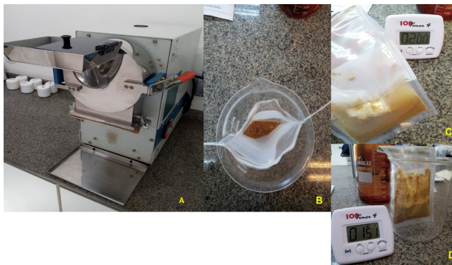
Figura 5 - Em (A) Moinho de rotor; (B) Amostra pesada; (C) Amostra no saco homogeneizador com água e extraction buffer bags; (D) Amostra em repouso
