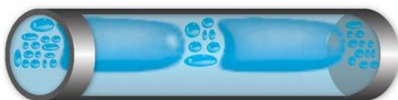
Figura 1-1 – Escoamento em Golfadas em Tubulação Horizontal Fonte: Bratland, 2010
