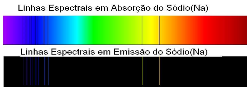
Figura 18 - Espectros de emissão e absorção para o Sódio
