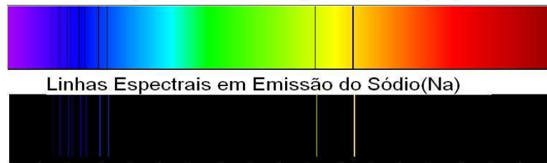
Figura 4 - Espectros de emissão e absorção para o Sódio Linhas Espectrais em Absorção do Sódio(Na)
