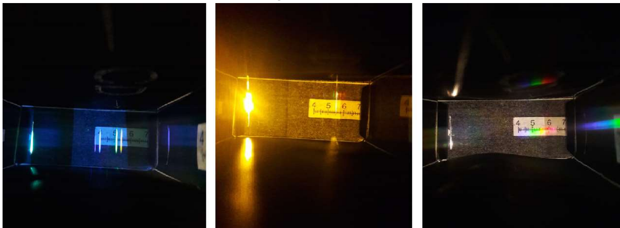
Figura 18 - Espectro de emissão de lâmpadas mercúrio, sódio e incandescente, respectivamente
