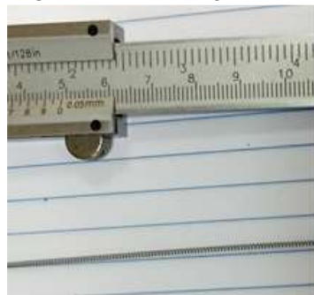
Figura 14 - Condições normal e comprimida da mola
