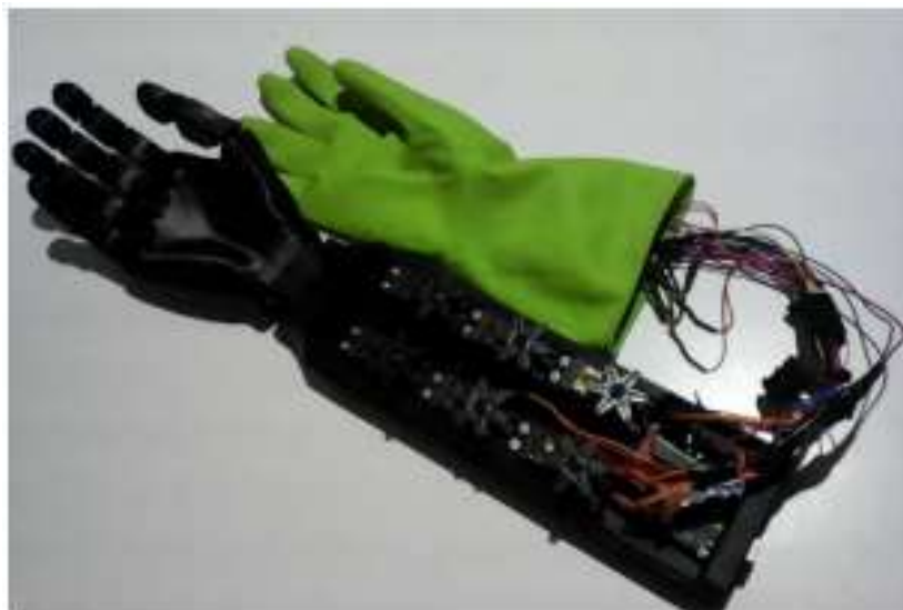
Figura 9 - Prótese robótica com motores na região braquial
