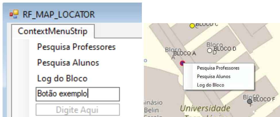
Figura 19 – Ilustração de um ContextMenuStrip , à esquerda adicionando botões e à direita botões prontos.
