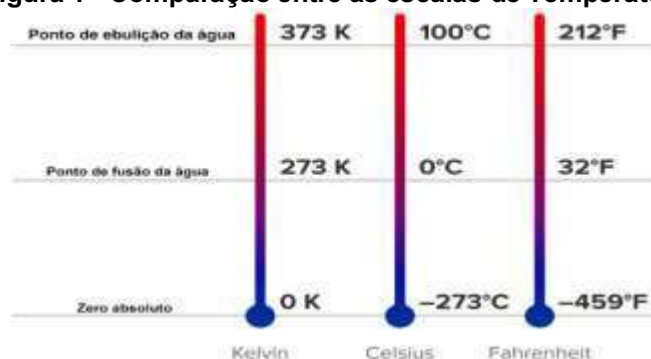
Figura 1 - Comparação entre as escalas de Temperatura
