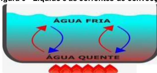
Figura 6 - Líquido e as correntes de convecção
