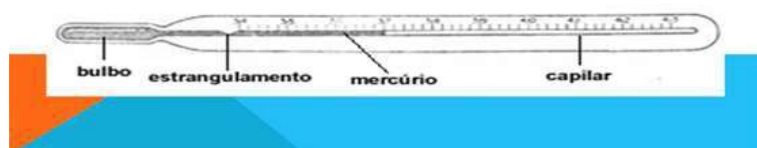
Figura 2 - Termômetro de Mercúrio Termômetro mais comum (Termômetro de bulbo)
