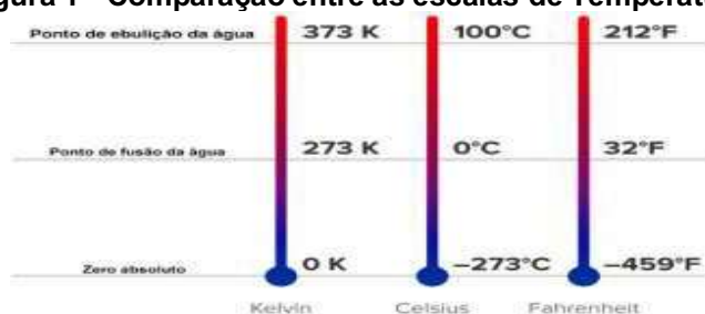
Figura 1 - Comparação entre as escalas de Temperatura.
