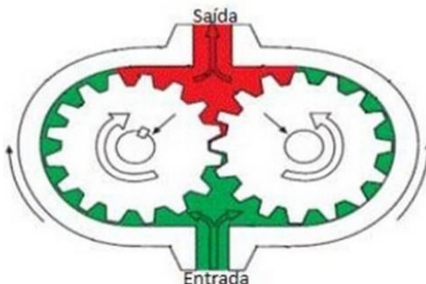
Figura 24 – Bombas de deslocamento positivo rotativas
