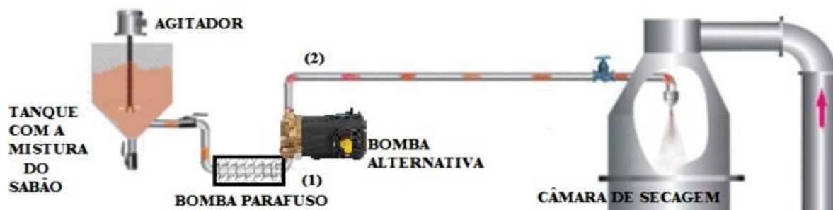
Figura 42 – Representação esquemática da etapa em que a bomba alternativa opera
