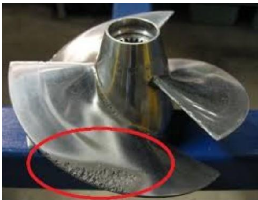
Figura 11 – Detalhe de rotor danificado pela cavitação
