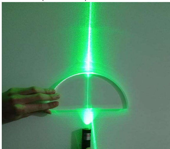
Figura 11 – Raio luminoso monocromático com incidência normal na interface entre dois meios diferentes (ar e acrílico) nenhum desvio ocorre.
