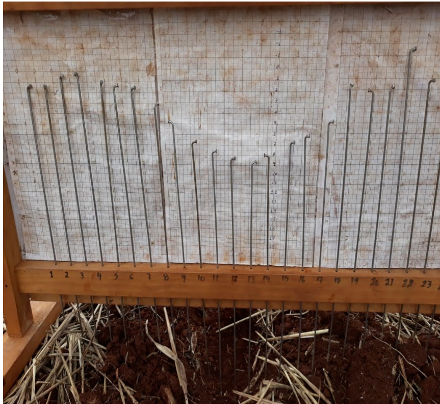
Figura 4 - Perfilômetro utilizado para avaliação da área de solo mobilizada e largura máxima de sulco
