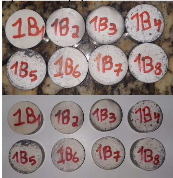
Figura A2 - Antes e depois dos bates propelentes sinterizados a 125 °C por 0,75 horas
