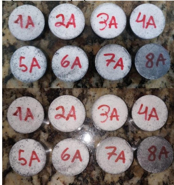
Figura A1 - Antes e depois dos bates propelentes sinterizados a 110 °C por 1,5 horas
