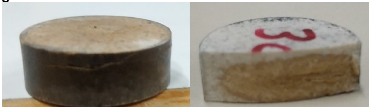
Figura 10 - Exterior e interior de um bate C^2 sinterizado a 140 \text{ }^\circ\text{C}
