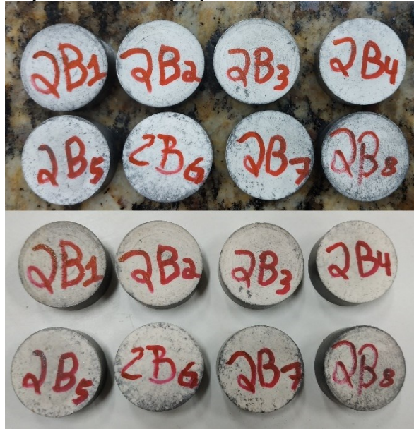
Figura A3 - Antes e depois dos bates propelentes sinterizados a 125 °C por 1,5 horas
