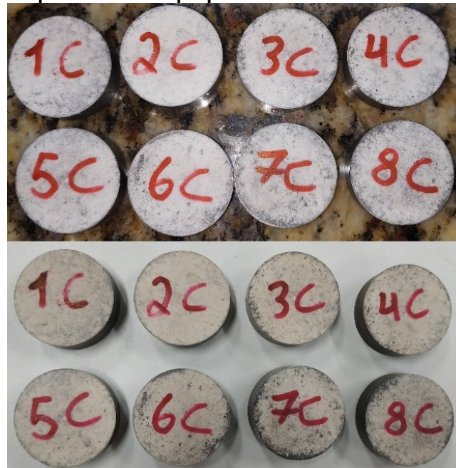
Figura 11 - Antes e depois dos bates propelentes C 2 sinterizados a 140 °C por 1,5 horas
