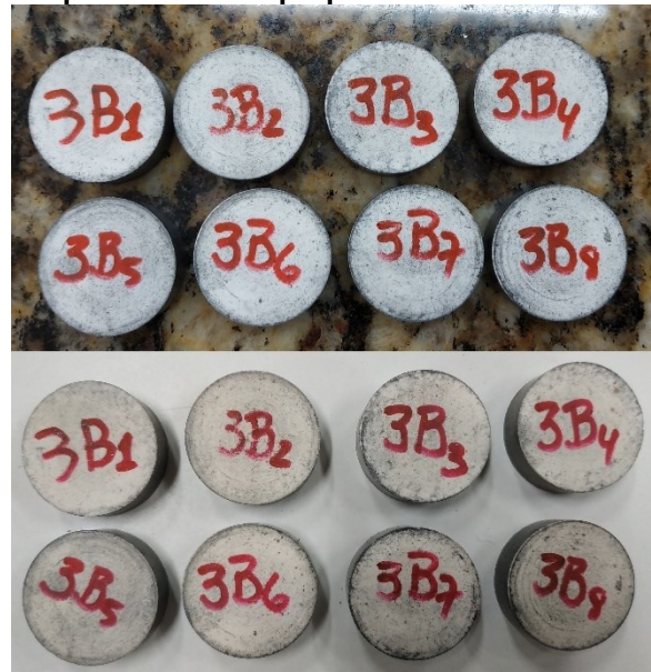
Figura A4 - Antes e depois dos bates propelentes sinterizados a 125 °C por 3 horas
