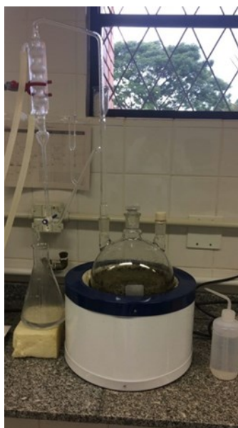
Figura 5 - Equipamento utilizado para extração do óleo essencial através de hidrodestilação. FONTE: OLIVEIRA, 2017.
