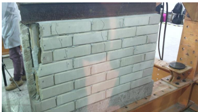
Figura 33 - Detalhe da vara de bambu no P 2, após rompimento Fonte: Aatoria própria (2016)
