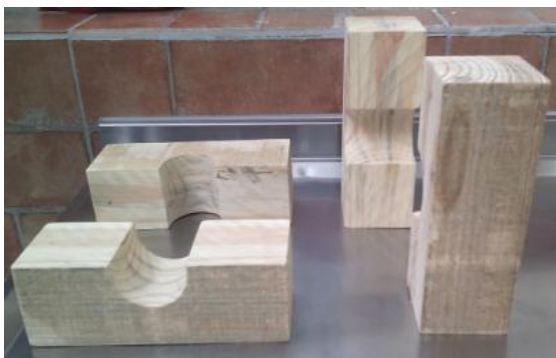
Figura 46 – Apoio com seção circular tipo “berço” utilizado no ensaio de flexão Fonte: Autoria própria (2017)
