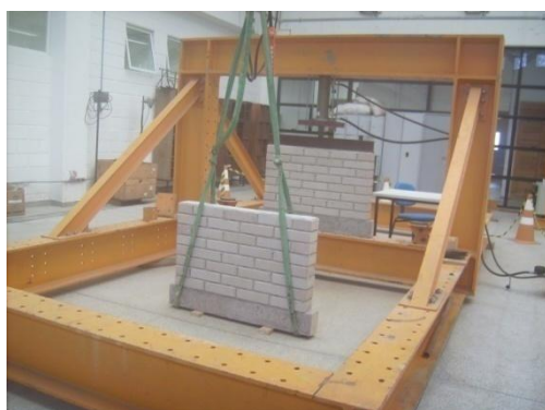
Figura 8 - Pórtico para ensaio de compressão Fonte: Autoria própria (2016)
