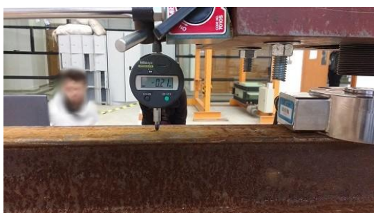
Figura 21–Transdutor digital de deslocamento posicionado próximo do eixo central Fonte: Autoria própria (2016)
