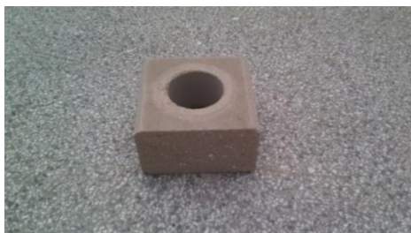
Figura 10 - Detalhe do bloco de solo-cimento (1/2 tijolo) - vista lateral Fonte: Autoria própria (2016)
