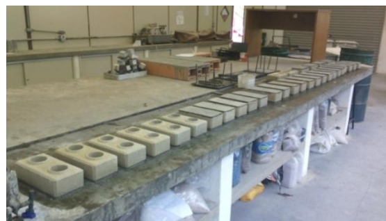
Figura 37 – Vista dos blocos de solo-cimento em processo de cura do capeamento Fonte: Autoria própria (2017)
