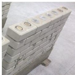
Figura 53 - Corpo de prova, CP 4, com estrutura de bambu nas extremidades Fonte: Autoria própria
