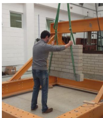
Figura 20 - Vista dos corpos de prova sendo colocados no pórtico
