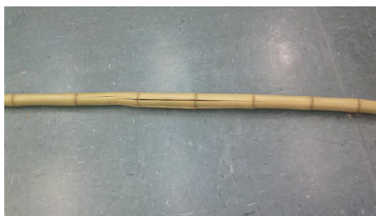
Figura 49 – Colmo de bambu após a ruptura Fonte: Autoria própria (2017)
