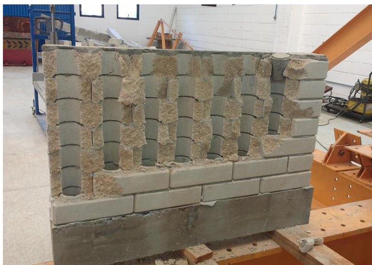
Figura 60 - CP 3 (sem estrutura em bambu) após o final do ensaio Fonte: Autoria própria
