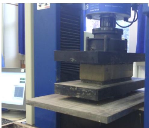
Figura 38 – Ensaio de compressão dos blocos de solo-cimento Fonte: A autoria própria (2017)
