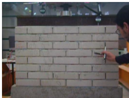
Figura 25 - P 1 Fissuramento final Fonte: Acervo do autor (2016)
