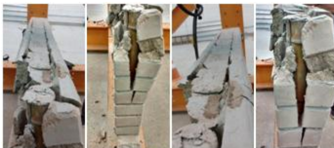
Figura 30 - Detalhe da vara de bambu posicionada na P 1 Fonte: Autorial própria (2016)
