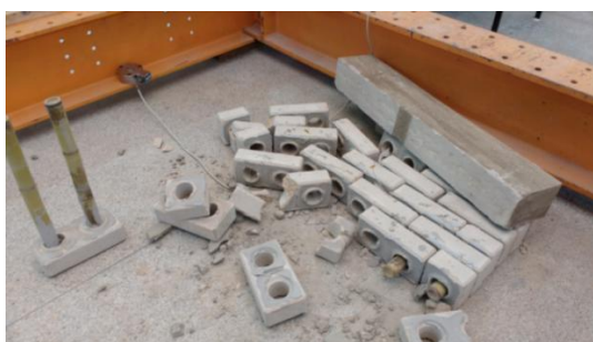
Figura 63 – CP 4 após rompimento
