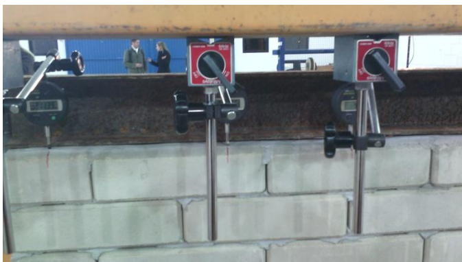
Figura 31 - P 2 – Relógios digitais medidores de dados posicionados (detalhe)
