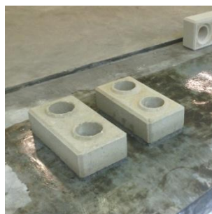
Figura 36 – Detalhe da bancada de trabalho com blocos de solo-cimento capeados Fonte: Autoria própria (2017)
