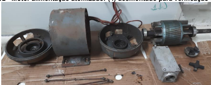
Figura 12 - Motor alimentação atomizador (4) desmontado para verificação e reparo.
