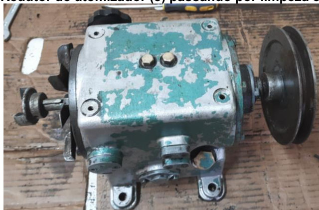
Figura 15 - Redutor do atomizador (8) passando por limpeza e verificação.
