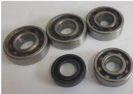
Figura 14 - Rolamentos substituídos nos motores reparados.
