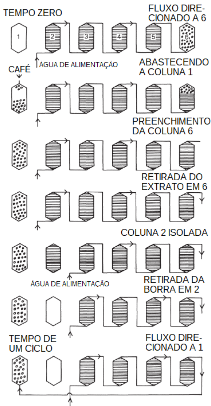
Figura 2 - Ciclo de extração e alimentação das colunas.
