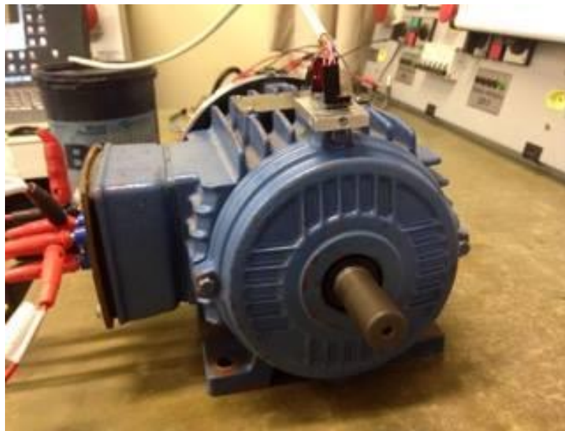
Figura 24: Posicionamento do acelerômetro ao MIT Fonte: Autoria própria
