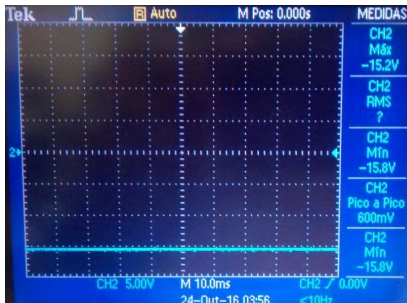
Figura 27. Sinal -15V da fonte simétrica de \pm 15 V Fonte: Autoria própria.
