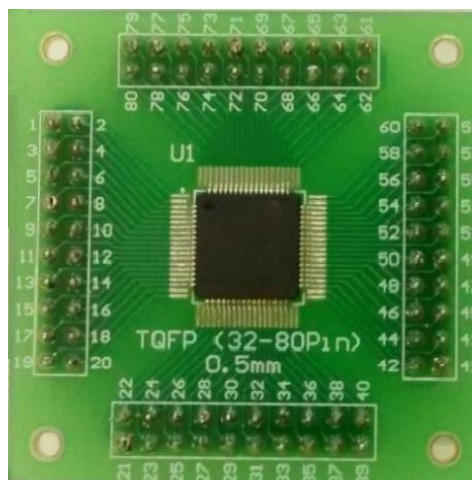
Figura 16. Adaptador SMD para DIP do microcontrolador Fonte: Autoria própria.
