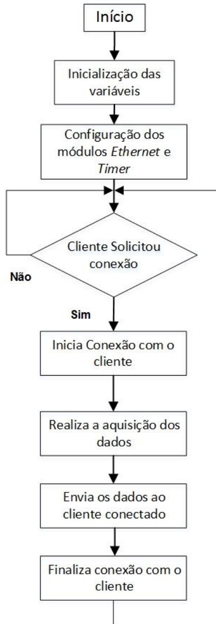
Figura 19. Fluxograma do algoritmo desenvolvido para a aquisição dos dados e comunicação TCP/IP. Fonte: Autoria própria.
